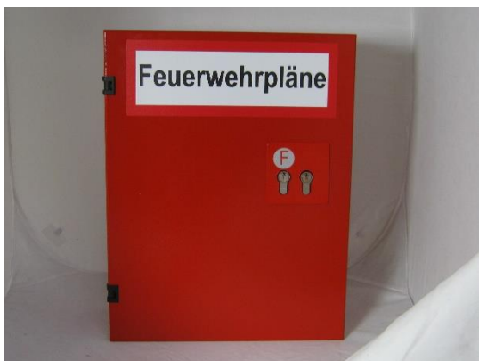
Bild 23 Der separate Blechkasten für den Feuerwehrplan wurde mit einer Doppelschließung ausgestattet. Das "F" kennzeichnet das Schloss für die Feuerwehr.
